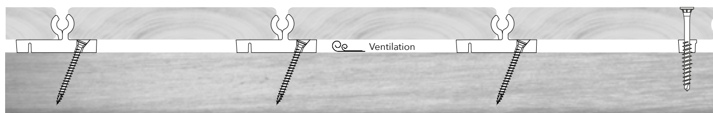
Teilsicht-Verschraubung bei End- und Startdiele
