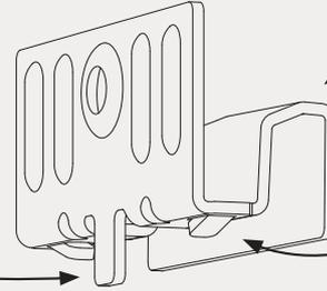
Schräg geführter Aufnahmeanschlag für ein einfaches Aufsetzen der Fassadenprofile
