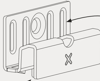
Stabilisierungszonen wirken den Verformungskräften zur Unterkonstruktion entgegen
