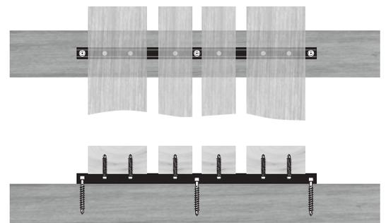
Die Holzlamellen werden je nach Dimension mit einer oder zwei Schrauben rückseitig fixiert. Zwischen den Lamellen wird die Befestigung zur Unterkonstruktion ausgeführt.
