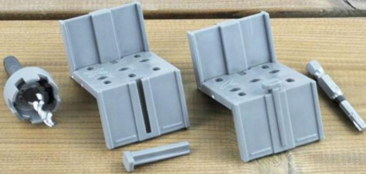
Der **HELPO Bohrsenker** ermöglicht in einem Arbeitsgang exakte und gleichmäßige Serienbohrungen und Senkungen für sichtbare Verschraubungen im Terrassenbau.
