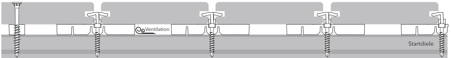
Teilsichtverschraubung bei Enddiele ohne seitlicher Nut
