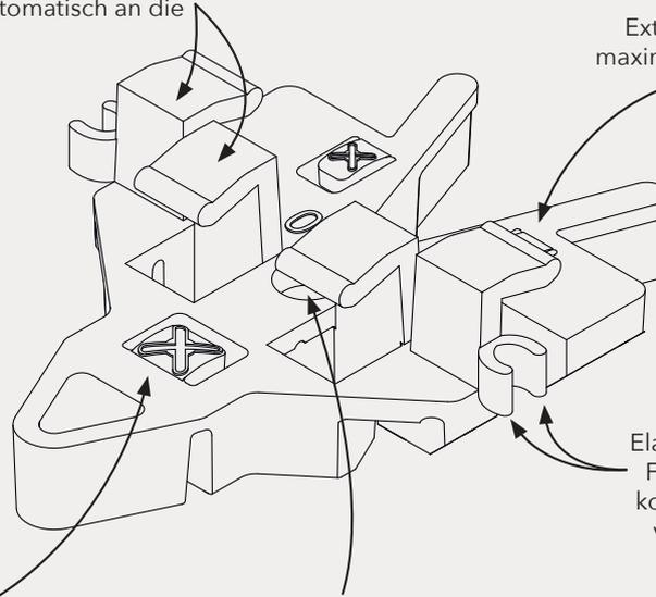
Extra große Grundplatte für eine maximale Auflagefläche der Dielen mit perfekter Hinterlüftung
