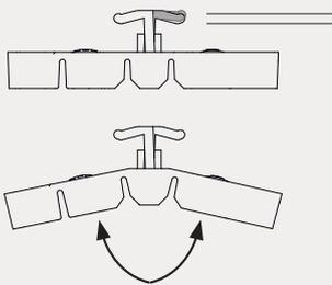
Dauerelastische Nutaufnahmen passen sich automatisch an die Nutposition an
