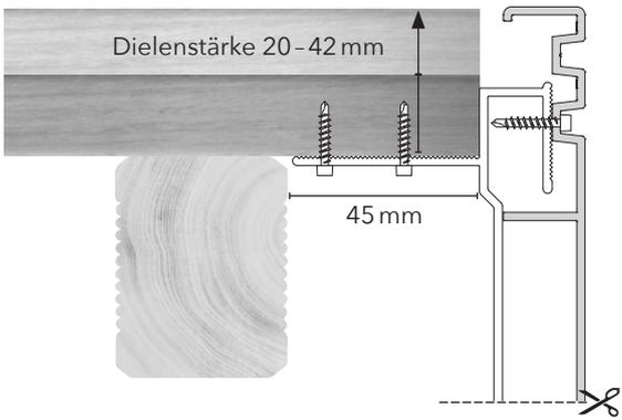
RELO VH wird mit der Diele mitverschraubt
