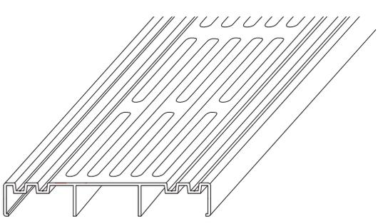
RELO V Ventilations- und Entwässerungsprofil
