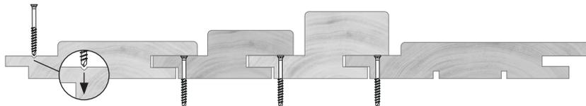
Verdeckte Verschraubung in den vorgesehenen Schraubmarkierungen
