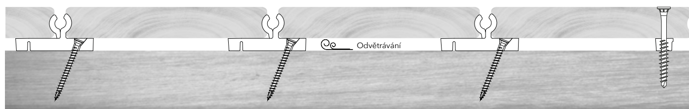
Zčásti viditelné šroubové spojení počátečního a koncového prkna
