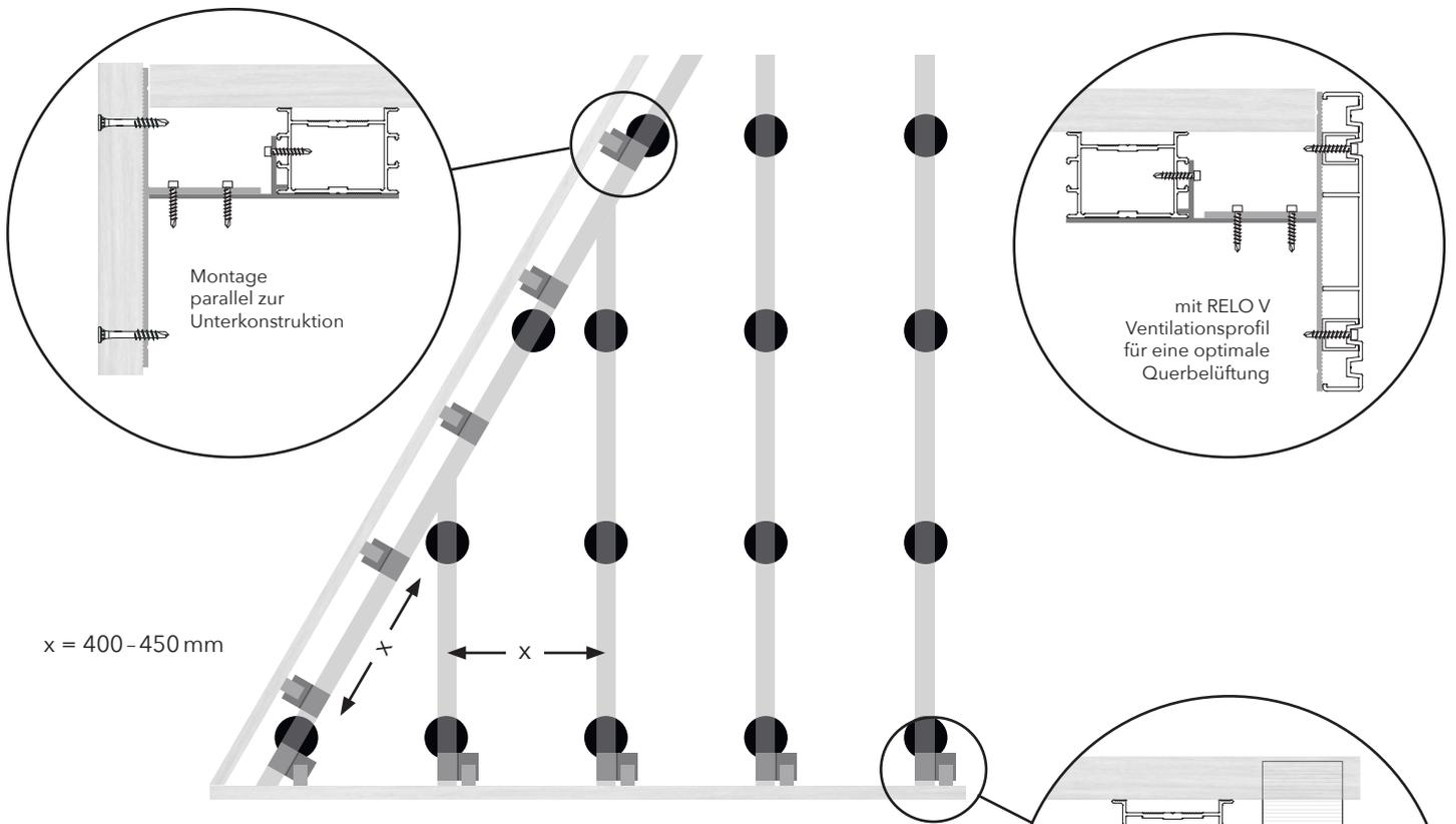
Montage parallel zur Unterkonstruktion
