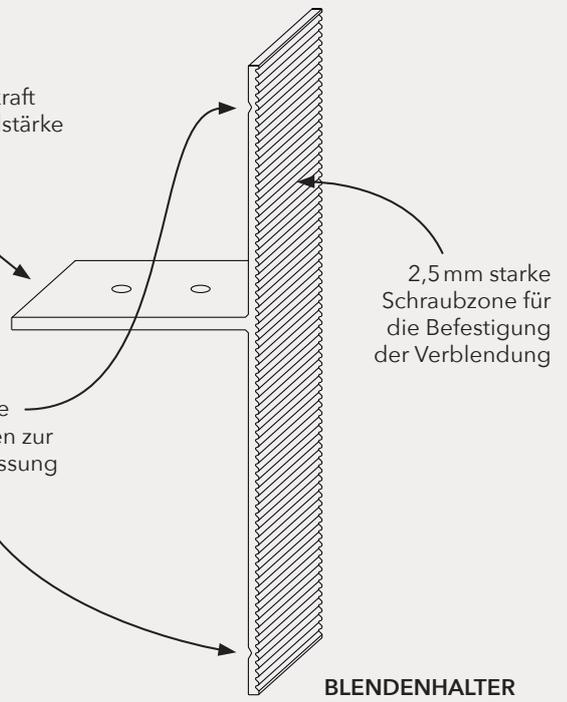
2,5 mm starke Schraubzone für die Befestigung der Verblendung
