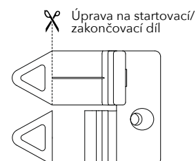
Zčásti viditelné šroubové spojení startovacího a koncového prkna
