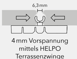
Ausklappmechanismus für einen einfachen Dielentausch
