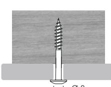
Die **Gleitpunkte** gleichen Dimensionsveränderungen der Fassadenplatte aus – die Fassadenschraube wird bündig anliegend verschraubt, so dass sich die Fassadenplatte noch zwangsfrei bewegen kann.
