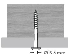
Der **Fixpunkt** hält die Fassadenplatte in Position – die Anordnung des Fixpunktes ist je nach Herstellerfabrikat unterschiedlich
