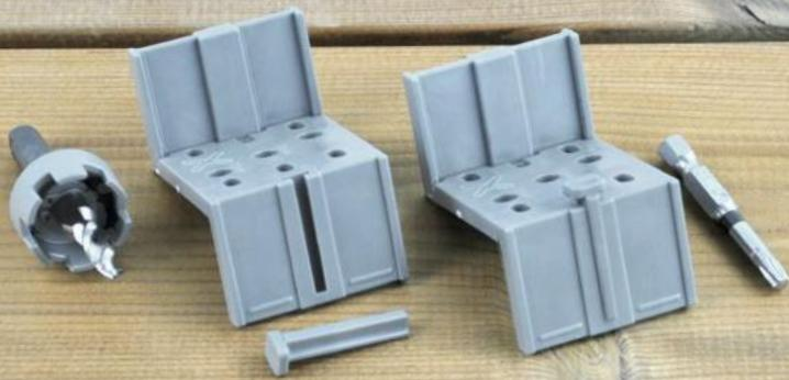
Der **HELPО Bohrsenker** ermöglicht in einem Arbeitsgang exakte und gleichmäßige Serienbohrungen und Senkungen für sichtbare Verschraubungen im Terrassenbau.
