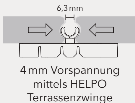
Ausklappmechanismus für einen einfachen Dielentausch
