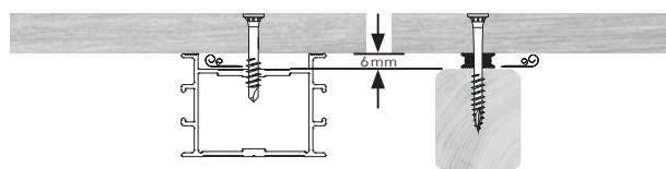
Un montage à distance (niveau de ventilation) d'au moins 6 mm assure une protection structurelle, réduit le gonflement et le retrait des lames ainsi que les effets de cisaillement exercés sur le matériel de fixation - éviter les surfaces de contact direct bois sur bois.
