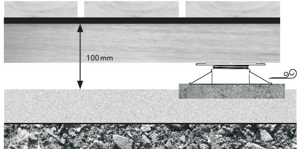
Une hauteur de construction à partir de 100 mm permet une ventilation optimale de l'ensemble de la structure. Des terrasses qui ne sont pas suffisamment ventilées peuvent provoquer des défauts, comme par ex. un gonflement des lames ou une défaillance ponctuelle du matériel de fixation.
