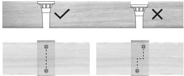
Les vis doivent être enfoncées de manière affleurante. Les têtes de vis trop profondément enfoncées favorisent l'accumulation de saleté et d'eau - cela peut provoquer des décolorations au niveau de la tête de vis. Les vis peuvent être placées de manière alignée ou décalée.
