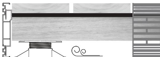
Les revêtements latéraux doivent être réalisés de manière à garantir la ventilation de l'ensemble de la structure, par ex. à l'aide du profilé de ventilation RELO V. Les revêtements fermés avec des planches de recouvrement peuvent entraver la ventilation et provoquer des perturbations.
