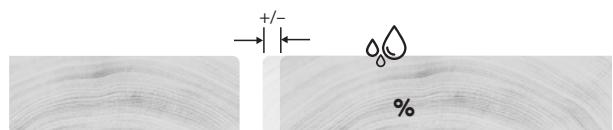
Le pourcentage d'humidité du bois doit être contrôlé avant de poser les lames. Une bonne humidité initiale du revêtement assure une terrasse sans défauts et fonctionnelle sur le long terme. Consulter le fournisseur du bois pour définir l'humidité optimale du bois.
