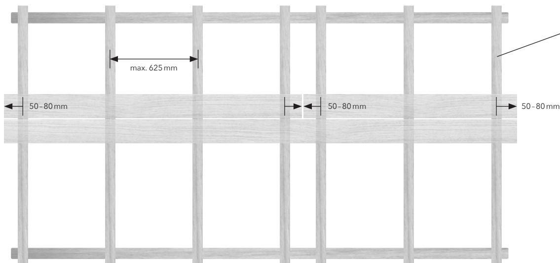
Espacements de fixation pour le revêtement de façade sur le lamage porteur.
