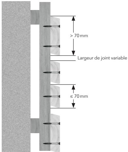
Les lattes à profil rhomboïde peuvent être réalisées avec différentes largeurs de joints, de la conception opaque à la conception ouverte.
