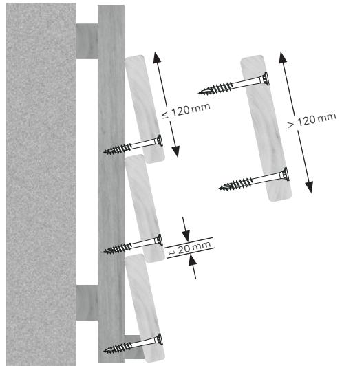
Les coffrages à clin nécessitent un recouvrement d'env. 20 mm. La profondeur de vissage dans la structure porteuse doit être de min. 25 mm.
