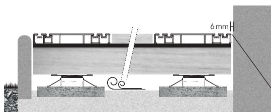
Le profilé de ventilation et drainage RELO V permet de réduire l'écart par rapport aux délimitations de 20 mm à 6 mm.
