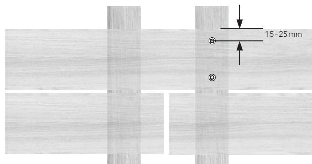
L'écart de vissage par rapport au bois latéral doit être de 15 à 25 mm selon la largeur des lames.
