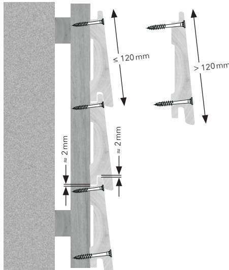
Les coffrages en planches profilées avec un assemblage par rainure et languette ont besoin d'un espacement de 2 mm entre le fond de la rainure et la languette pour pouvoir compenser les gonflements.
