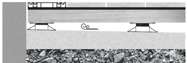
Pour les terrasses ou les bordures adjacentes en pierre, en béton ou en céramique (à la hauteur du revêtement), il convient d'utiliser des profils de ventilation pour garantir une ventilation optimale. Si cela n'est pas possible, un écart d'au moins 20 mm est nécessaire.
