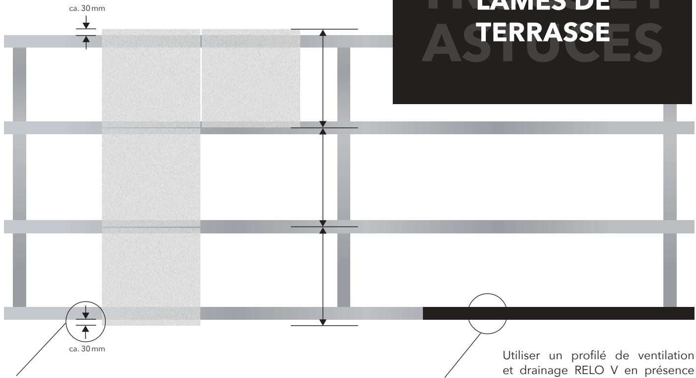
Les rangées de lames extérieures doivent dépasser d'environ 30 mm afin de pouvoir installer les profilés de fermeture de bord RELO RA.
