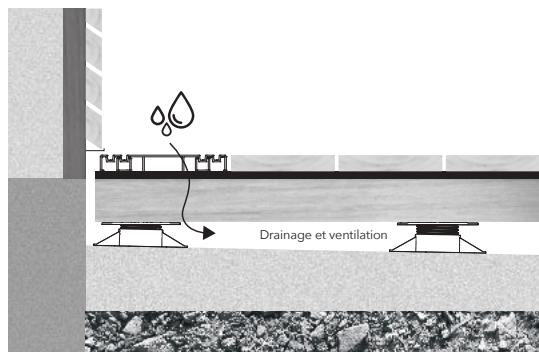
Le long d'objets adjacents tels que les façades ou en cas de portes coulissantes et battantes, etc., il convient d'utiliser des profilés de ventilation et drainage RELO V afin d'assurer une ventilation, une évacuation de l'eau et une réduction des salissures dues aux projections d'eau optimales.
