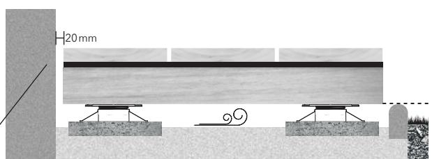
Des délimitations doivent permettre la ventilation de l'ensemble de la structure. Un espacement de 20 mm minimum est requis. Pour une construction optimale, la structure porteuse de terrasses doit être installée au-dessus des bordures de terrasse adjacentes.
